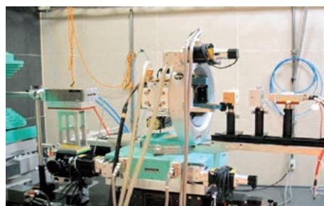
図1 共鳴X線磁気散乱測定装置
