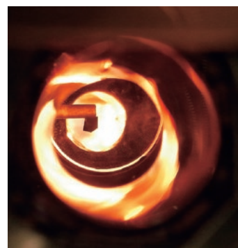
図2 Cuセル中に成長させた固体パラ水素結晶
