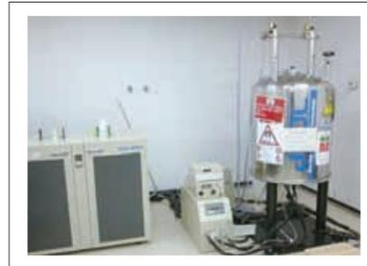
固体400MHz超伝導NMR装置
