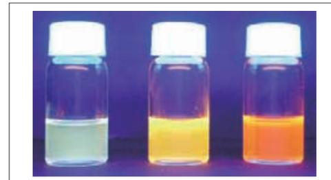
図3 不純物ドーブ半導体ナノ粒子DAへ発光
