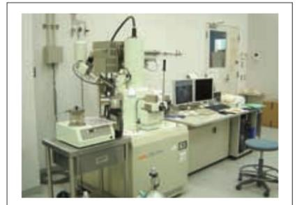
電界放射型走査電子顕微鏡 電子顕微鏡
