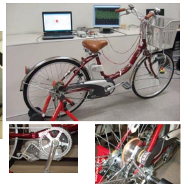
図5: 電動自転車のパワーアシスト制御
