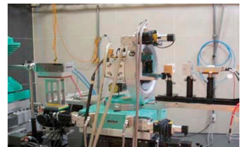
図1. 共鳴 X 線磁気散乱測定装置
