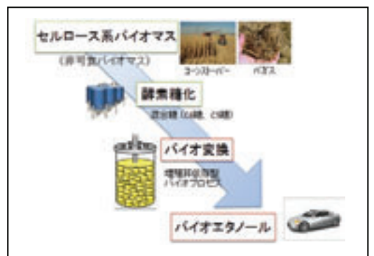
図3 増殖非依存型バイオプロセスの応用例 非可食バイオマスを原料としたバイオエタノール生産
