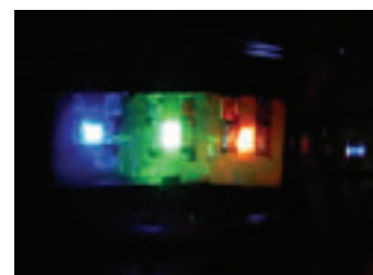
図2 カーボンナノチューブを用いたフィールドエミッションデバイス
