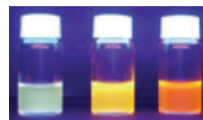
図3 不純物ドーブ半導体ナノ粒子 DA ペア発光
