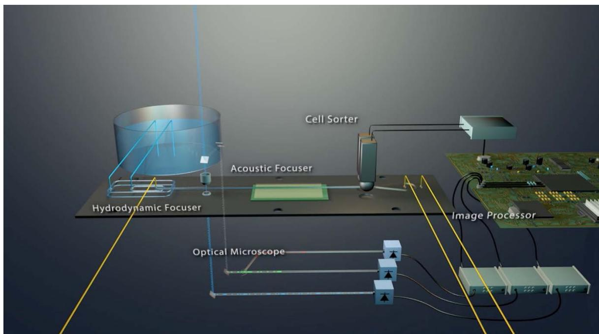
動画 1. 本技術の機能。超高速蛍光イメージング技術、10 ギガビットイーサネットによる高速データ処理システム、マイクロ流体技術を活用した高速分取技術や細胞制御技術など、複数分野にまたがる異分野融合により実現しました。
