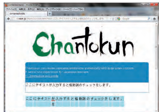
図3: Chantokun: 日本語学習者の作文の誤り検出・訂正インタフェース。格助詞の使用誤りを検出し、訂正候補を示します。
