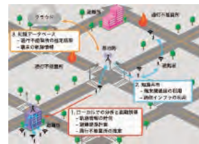
図: モバイルデバイスを使用した避難誘導システム
