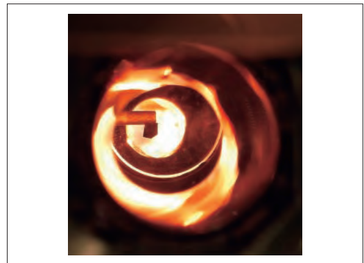
図2 Cuセル中に成長させた固体パラ水素結晶
