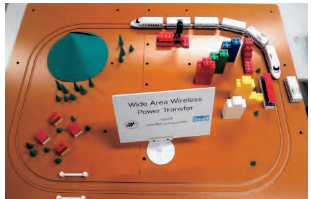
ブラレールを使った無線電力伝送実験
