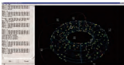
図3 電磁的な外乱により漏えいする情報の可視化
