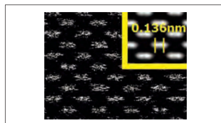
Si単結晶(110)面の超高分解能観察像
