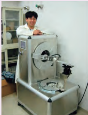
高解像度ピンホールSPECT装置を独自に開発し、マウスの機能イメージングに成功しました
