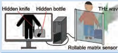
図4 ローラブルなマトリクス型THz波センサによるセキュリティチェックのイメージ図
