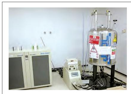
固体400MHz超伝導NMR装置
