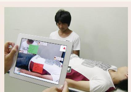
電子トリアージを用いた救命救急システム：携帯端末を向けた方向にいる患者の生体情報がリアルタイムに表示される様子
