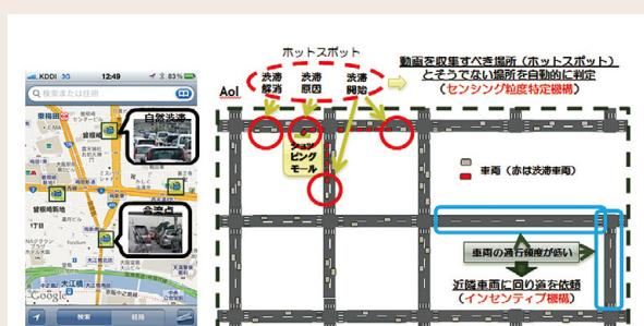
ユーザ参加型センシングによる渋滞情報の収集・配信システム：渋滞発生地点の動画を効率よく収集し、その地点にこれから向かうユーザーが所有する端末へ配信する
