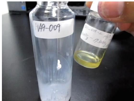
力学的強度を改善した感熱応答性生分解性ポリマー
