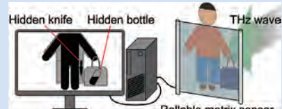
図4 ローラブルなマトリクス型THz波センサによるセキュリティチェックのイメージ図
