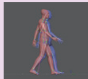
図1：青が従来の運動計測、赤がIMUセンサを用いた運動計測
