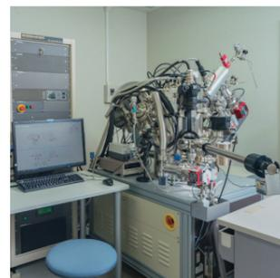
物質表面の構成元素の組成分析、化学状態分析、定量分析を非破壊的に分析する装置です。試料に特性X線を照射し、放出された光電子のエネルギーを測定することで、数nm程度の表面の分析が可能です。
