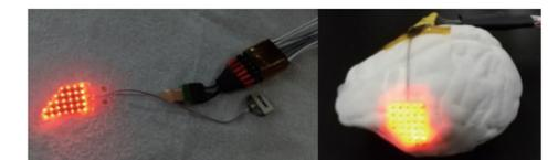
図1：光刺激・計測電極積層2次元アレイデバイスの外観(左)とサル脳模型上設置(右)
