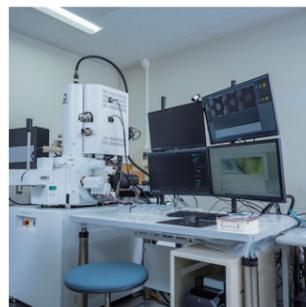
電子線を用いて様々な観察・分析を行うことができる走査電子顕微鏡です。通常の像観察はもちろんのこと、EDS、EBSD、CLと3つの検出器を搭載しており、元素分析から結晶方位、固体の電子状態などの分析も可能です。
